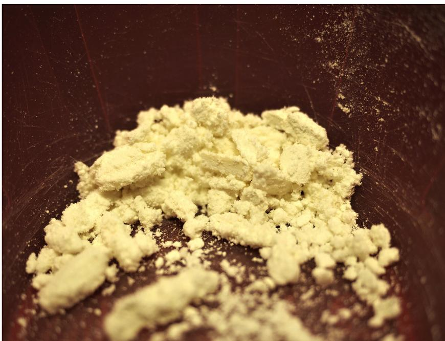
Abb. 5: Rückstände des Diepflinger Leitungswassers nach gelinder Abrauchung.
