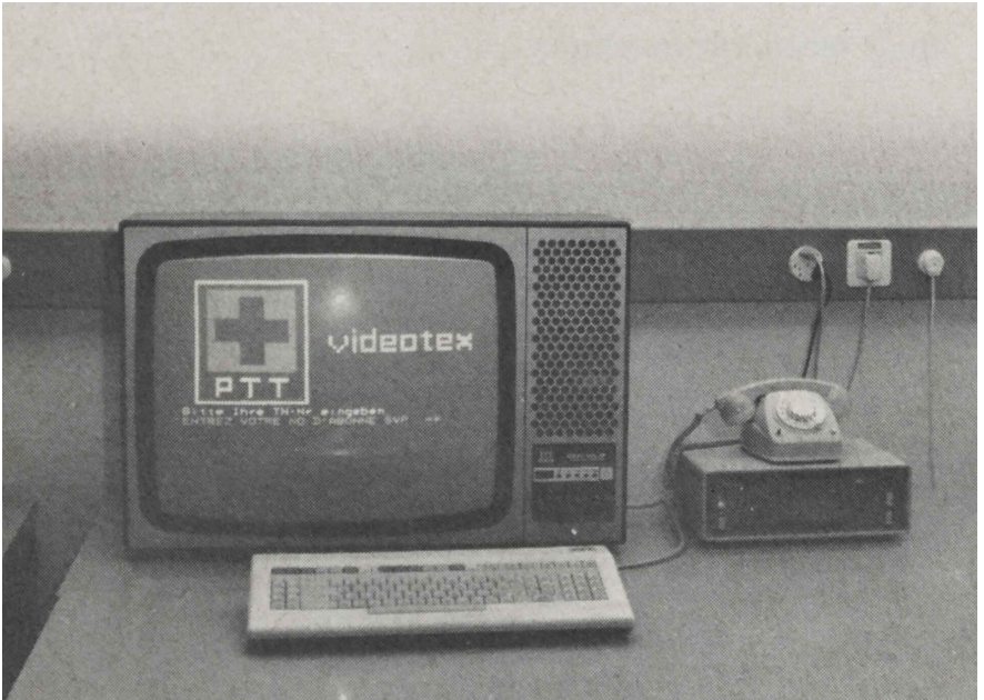
Abb. 3: Eine Videotex-Anlage mit Fernsehgerät, Tastatur, Modem und Telefon, 1979.
